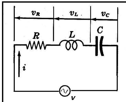
$$v = v_R + v_L + v_C \quad v = V_0 \sin \omega t$$
