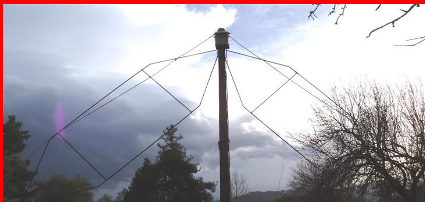
Εικόνα 3: Φωτογραφία του ακίνητου παχέως διπόλου σχήματος ανεστραμμένου V. Στην κορυφή του στύλου διακρίνεται το κουτί με τους ενισχυτές και τα φίλτρα.
