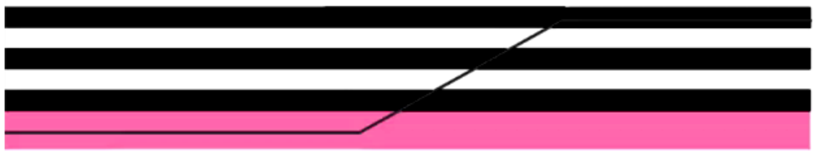
Πτυχές (λόγω) κάμψεων ρήγματος (fault-bend folds)
