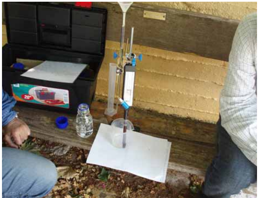
Μετρήσεις υπαίθρου φυσικοχημικών ιδιοτήτων σε πηγή φυσικού μεταλλικού νερού.
