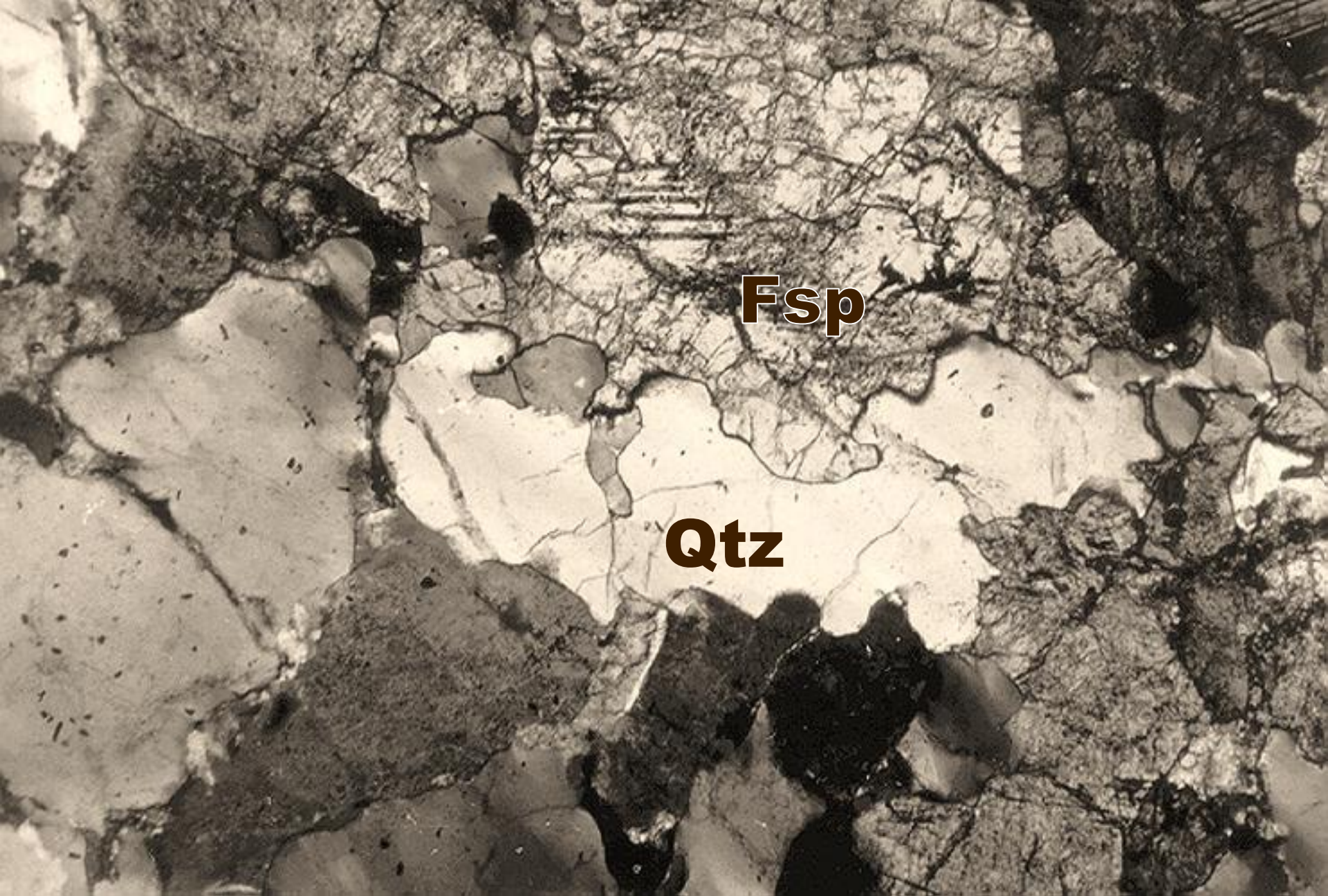
Γνεύσιος με λοβοειδή όρια κρυστάλλων (ιδίως ανάμεσα σε χαλαζία και αστρίους), που σηματοδοτούν την παραμόρφωση σε συνθήκες υψηλού βαθμού μεταμόρφωσης και GBM ανακρυστάλλωση.
