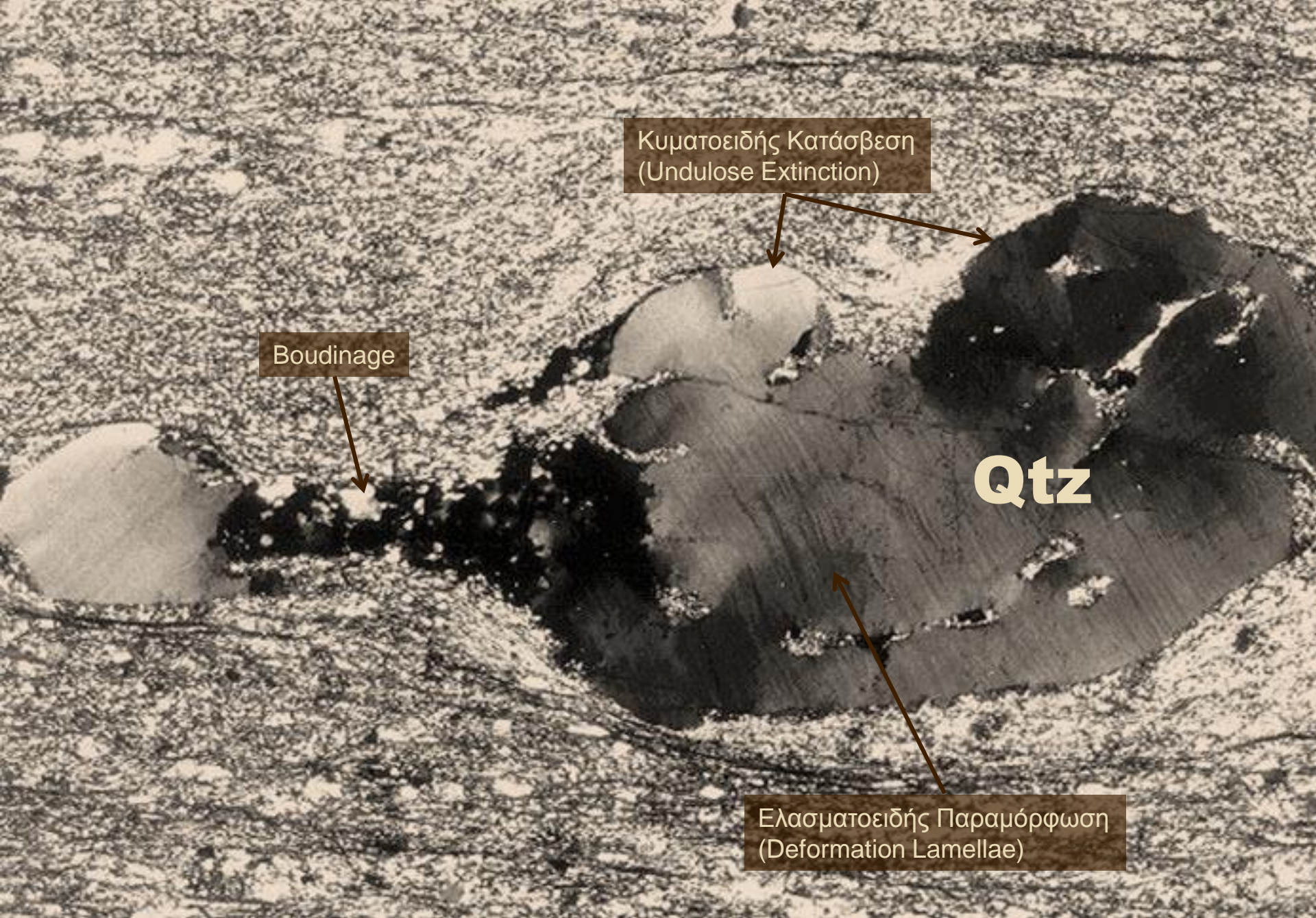
Κρύσταλλος χαλαζία (Qtz), που έχει πεπλατυνθεί (flattening) λόγω ενδοκρυσταλλικής παραμόρφωσης.
