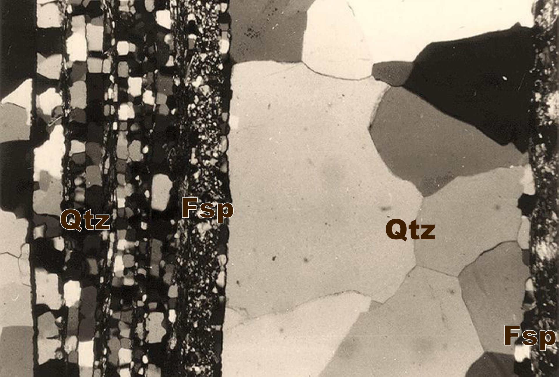
Χαρακτηριστικός ιστός στατικής ανακρυστάλλωσης με εναλλαγές στρωματιδίων από χαλαζία και αστρίους. Το μέγεθος των κρυστάλλων βρίσκεται σε άμεση συνάρτηση με το πάχος των στρωματιδίων.
