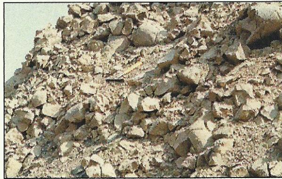
Φωτ. 10. Σκουριές και γαιώδες υλικό.
