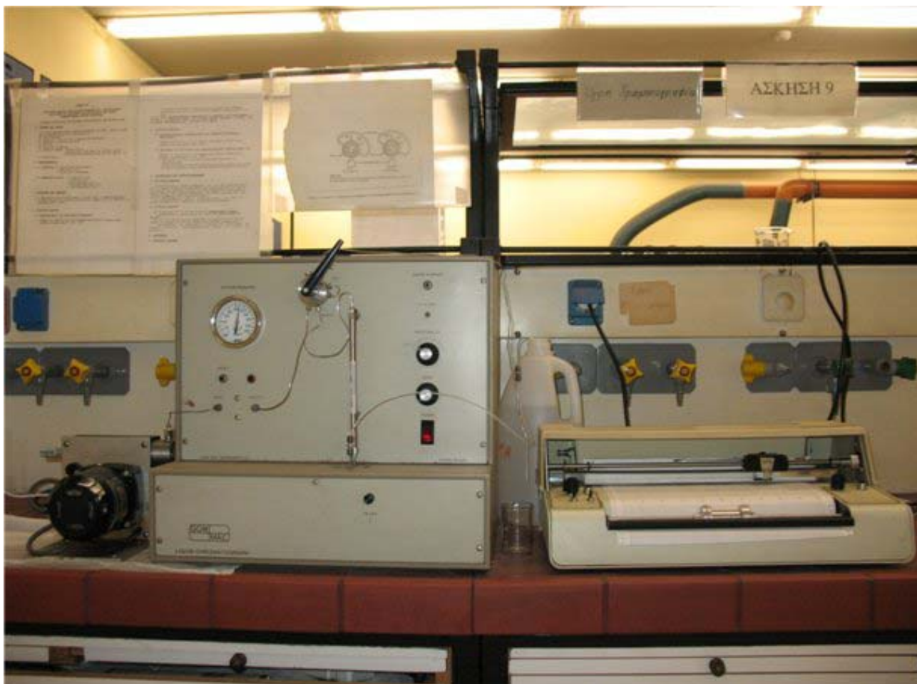
Σχήμα 1. Εργαστηριακή διάταξη υγροχρωματογράφου υψηλής απόδοσης (Gow-Mac 80-650) με την αντλία (αριστερά) και τον καταγραφέα (δεξιά).
