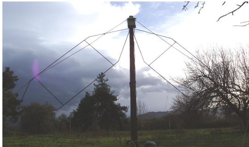
Εικόνα 3: Φωτογραφία του ακίνητου παχέως διπόλου σχήματος ανεστραμμένου V. Στην κορυφή του στύλου διακρίνεται το κουτί με τους ενισχυτές και τα φίλτρα.
